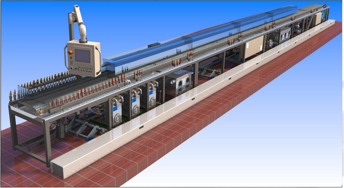
**Kalibriertisch für Trockenkalibrierwerkzeuge, Vakuumtanks und weitere Aufbauten**
